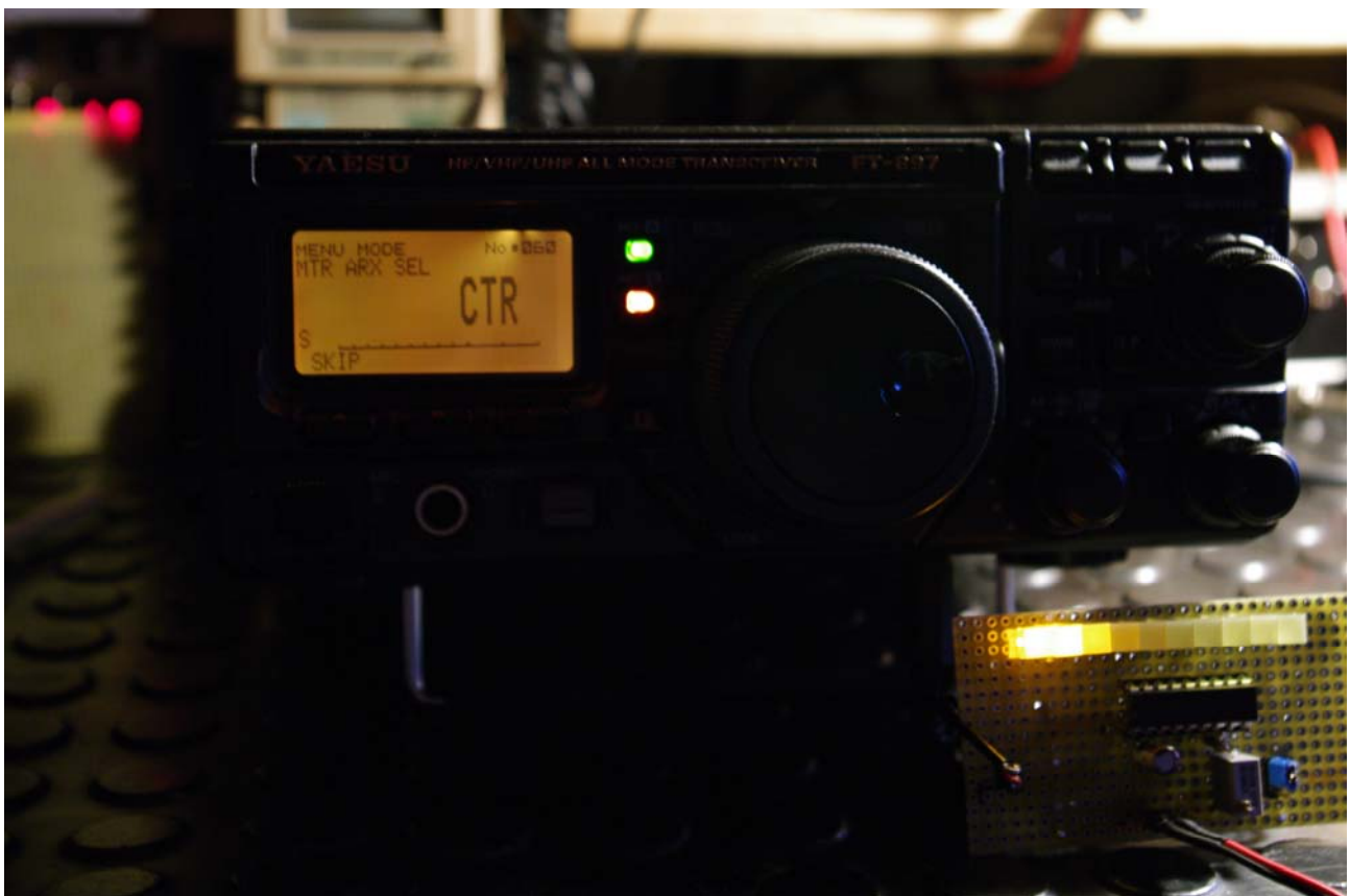
Figura 3 Il voltmetro collegato all'897
